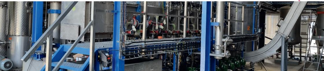
Le projet GAIA porté par Exinnov vise à développer l'extraction végétale à l'aide de solvants biosourcés. L'adaptation de matériels précédemment utilisés avec de l'hexane, a permis la mise en service d'un extracteur industriel continu à contre-courant résistant aux contraintes du 2-méthylxolane, un solvant vert produit à partir de sous-produits de l'industrie agroalimentaire.
